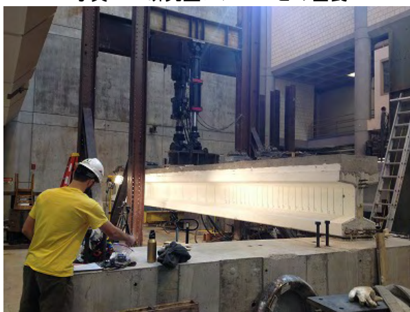
写真 6 実験室での載荷実験
