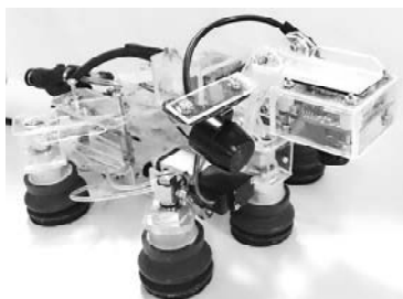
自走式小型点検ロボット
