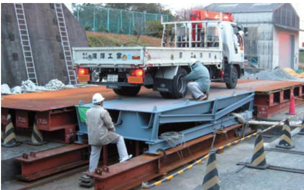
実トラックによる載荷試験の様子
