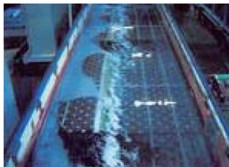
図-1 複断面実験水路における大規模水平渦
