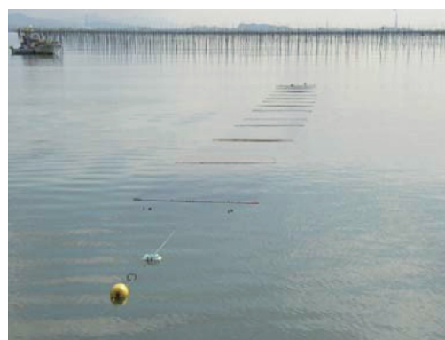
図-2 有明海におけるノリ養殖施設流体抵抗計測実験
